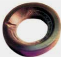
被腐蚀后的球体密封
